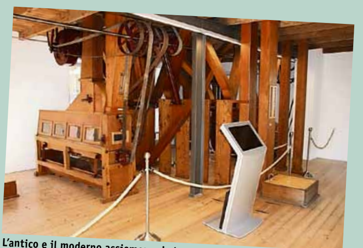
Al piano terreno ruote a ingranaggi e pulegge per trasmettere il movimento ai piani superiori.
