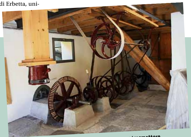
Al piano terreno ruote a ingranaggi e pulegge per trasmettere il movimento ai piani superiori.
