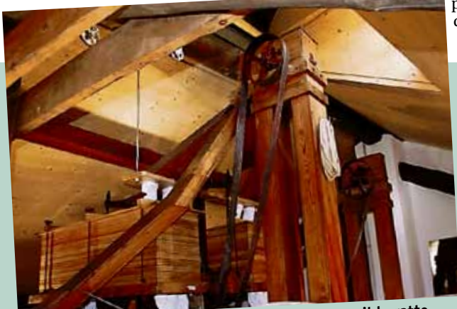
Pulegge e cinghie fin nel sottotetto dove si trova il buratto.
