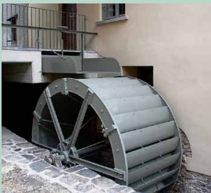
La ruota idraulica con cassetti che aziona il complesso macchinario.
